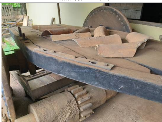
Foto 06: Estrutura da mesa apresenta manchas enegrecidas, desgaste superficial e acúmulo de sujidades. Autor: Gabriela Macedo Data: 03/11/2020
